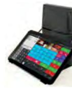
Torretta display cliente 2x16 LCD retroilluminato + supporto tablet regolabile\*
