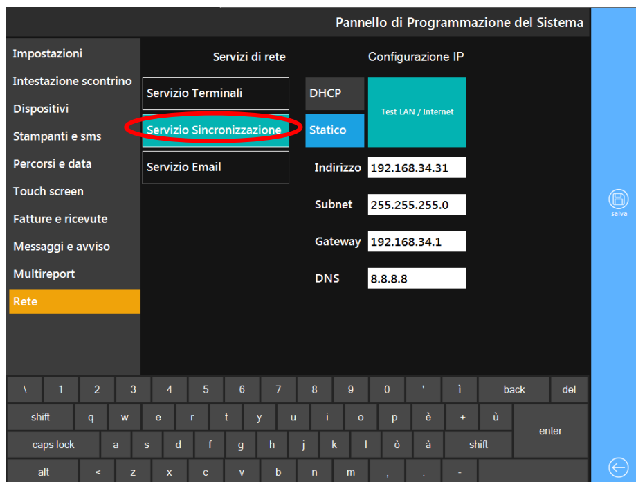
Figura 168: Abilitazione/Disabilitazione Servizio di Sincronizzazione
